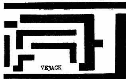
Parts List R1, R4 - 100k, 1/8W C1, C2 - 10uF, 25V R2, R5 - 27k, 1/8W Q1, Q2 - 2N2222 R3, R6 - 1k, 1/8W D1, D2 - LED
